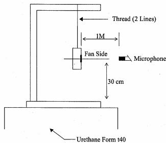
1 METER FROM MICROPHONE TO FAN INTAKE
