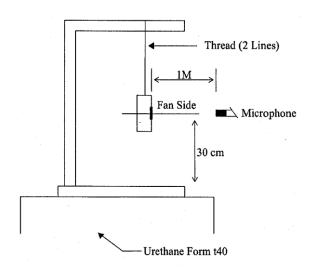
1 METER FROM MICROPHONE TO FAN INTAKE
