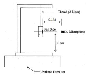
0.1 METER FROM MICROPHONE TO FAN INTAKE
