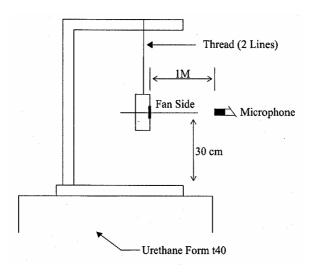
1 METER FROM MICROPHONE TO FAN INTAKE
