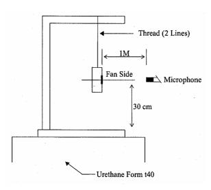
1 METER FROM MICROPHONE TO FAN INTAKE
