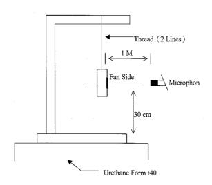
1 METER FROM MICROPHONE TO FAN INTAKE
