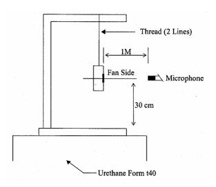
1 METER FROM MICROPHONE TO FAN INTAKE
