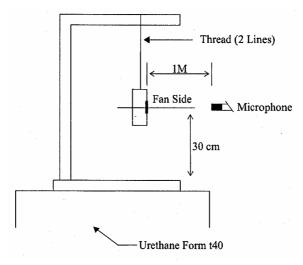
1 METER FROM MICROPHONE TO FAN INTAKE
