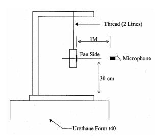
1 METER FROM MICROPHONE TO FAN INTAKE
